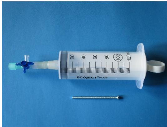
Der Spritzenkolben wird mittig zweimal so durchbohrt (5 mm), dass eine Schraube mit 4 mm Durchmesser und einer Länge von 7 cm in das Bohrloch hineinpasst und den Kolben so fixiert, dass die Spritze ein Volumen von 100 mL bzw. 120 mL besitzt.
