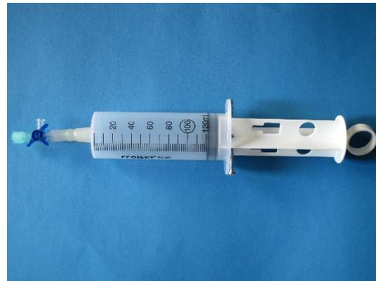
Als Hilfe zum Durchstechen der Schraube beim Aufziehen des Vakuums ist der Kolben doppelt durchbohrt (5 mm), sodass die Schraube in jeder Richtung durchgesteckt werden kann.
