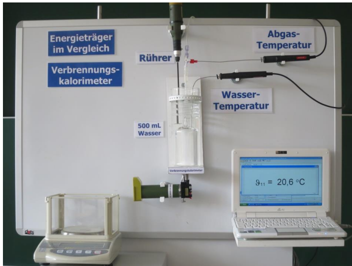
Abb. 17 Versuch 23.1 Messung der Wasser- und Abgastemperatur mit zwei Thermofühlern
